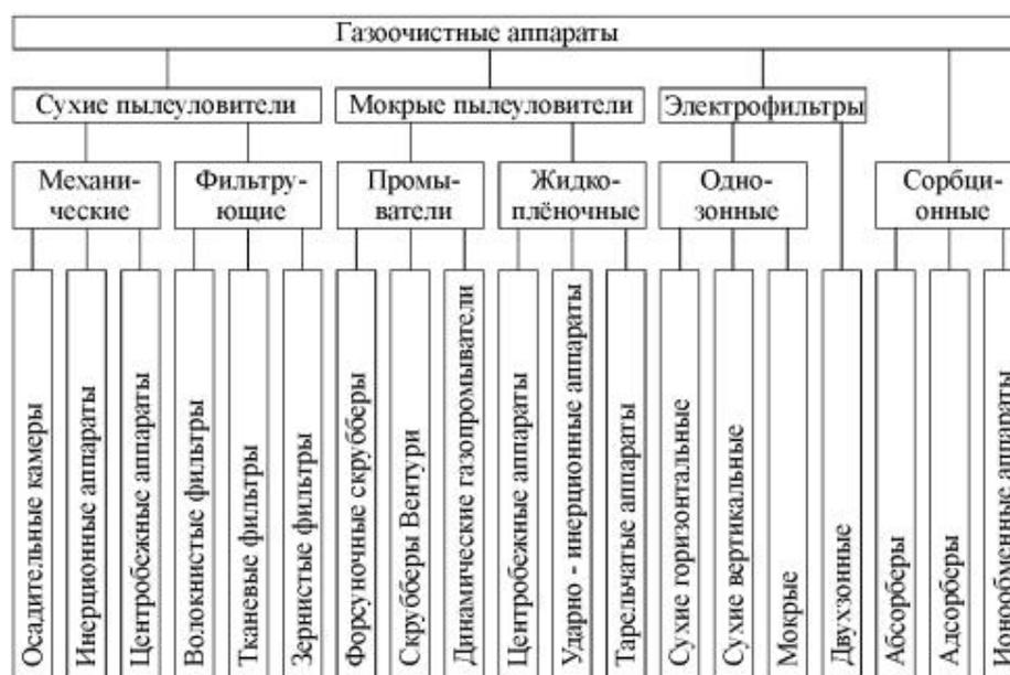
Рис. 1.1. Схема классификации пылеулавливающего оборудования
