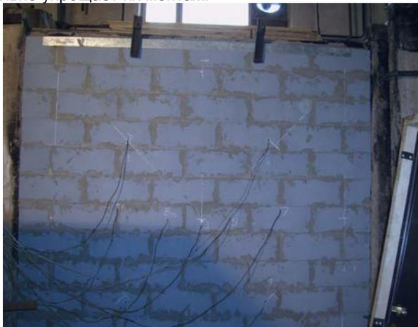
**Рисунок 1** Определение огнестойкости фрагмента толщиной 100 мм из газозолобетона марки D500 ООО «ПСО «Теплит»
