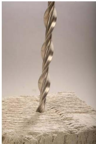
**Рисунок 1. Общий вид гибкого спиралевидного ремонтного стержня из нержавеющей стали, установленного в ячеистый бетон**
