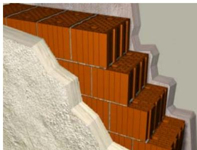
**Рисунок 6. Теплоизоляционные перлитовые штукатурки**
