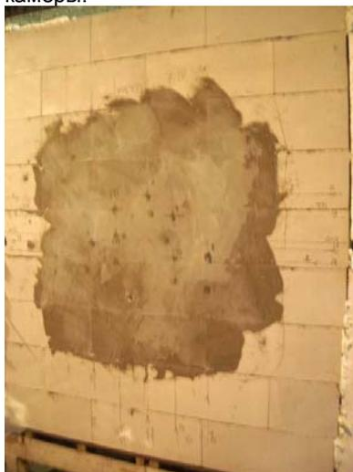
**Рисунок 2. Общий вид испытываемого фрагмента кладки из пазогребневых блоков 300 x 250 x 625 мм со стороны холодного отсека климатической камеры**
