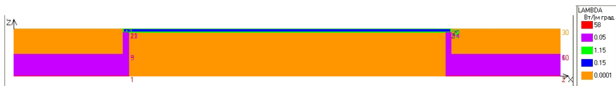
Рисунок 3. Расчетная схема покрытия с зенитным фонарем в программном комплексе TEPЛ (см. сечение 1-1, рис. 1) Разными цветами показаны области с разным коэффициентом теплопроводности
