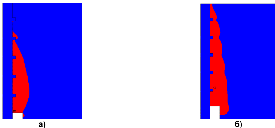
Рисунок 2.3. Зоны пластичности в задаче о вытягивании профилированной арматуры из бетонного блока (показан фрагмент). Упругопластическое решение с применением критерия Друккера – Прагера без учета упрочнения (а) и с его учетом (б) для случая жесткого монотонного нагружения ( u_z = -60 мкм)
