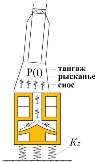
Рисунок 2. Модель стартового сооружения [1]
