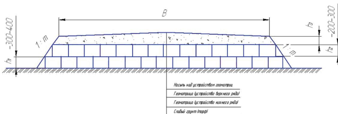
Рисунок 4. Схема применения геоматриц на болотах 2 типа [7]
