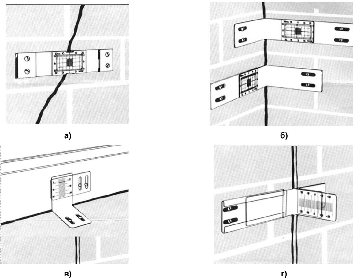
**Рисунок 2. Возможные схемы установки измерителей трещин:**
