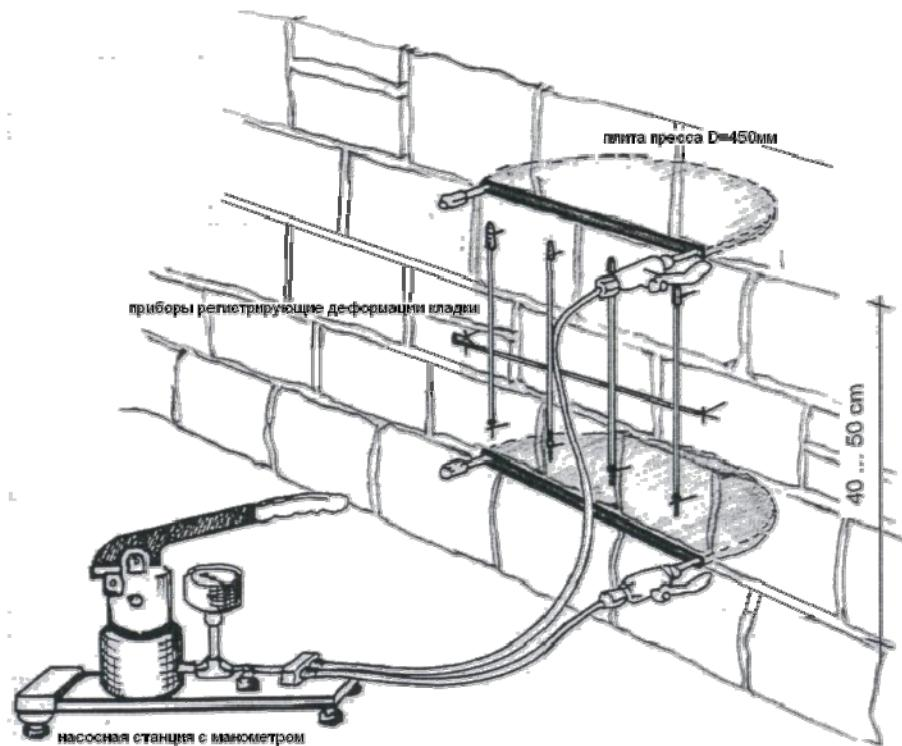
Рисунок 5. Схема испытаний каменной кладки методом «Flat-Jack-Tests»
