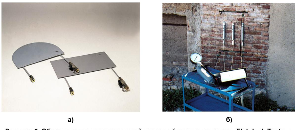
Рисунок 6. Оборудование для испытаний каменной кладки методом «Flat-Jack-Tests»:
