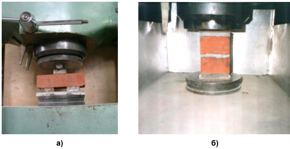
**Рисунок 3. Испытания кирпича керамического: а – на изгиб, б – на сжатие**
