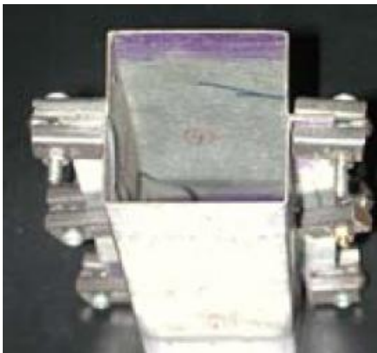
Рисунок 3. Пример (прототип) составной колонны, работа которой была исследована в университете Сиднея
