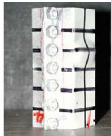
Рисунок 10. Экспериментальные результаты для местной потери устойчивости колонны, полученные в университете Сиднея
