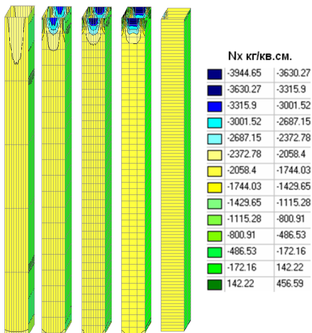
Рисунок 6. Результаты численного моделирования колонны: поля напряжений по оси X
