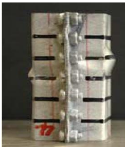
Рисунок 10. Экспериментальные результаты для местной потери устойчивости колонны, полученные в университете Сиднея
