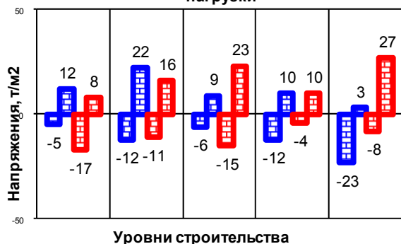
Экстремальные напряжения за расчетный период возведения в простенках кирпичной стены толщиной 640мм от температурной нагрузки
