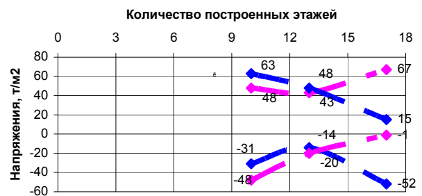
Экстремальные напряжения в сплошной кирпичной стене толщиной 640мм на 8-10 этажах (уровень 3)
